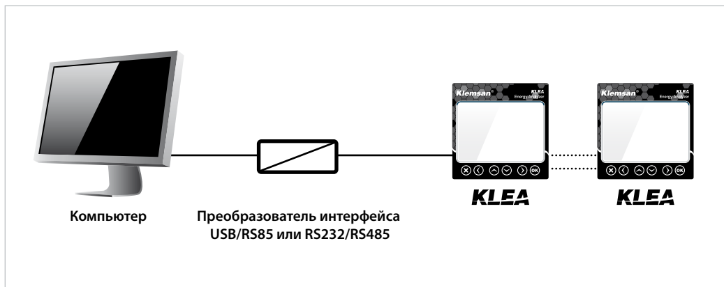
Рис. 4-2 Соединение ПК с анализатором KLEA по линии RS485
