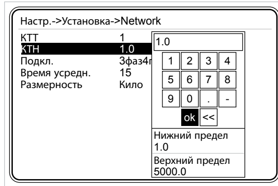
Рис. 3-15 Настройка коэффициента трансформации ТН
